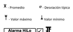
Permite al Medidor avisar al usuario con una señal visual y sonoara cuando las medidas no se adecúen a los límites determinados por el usuario.
