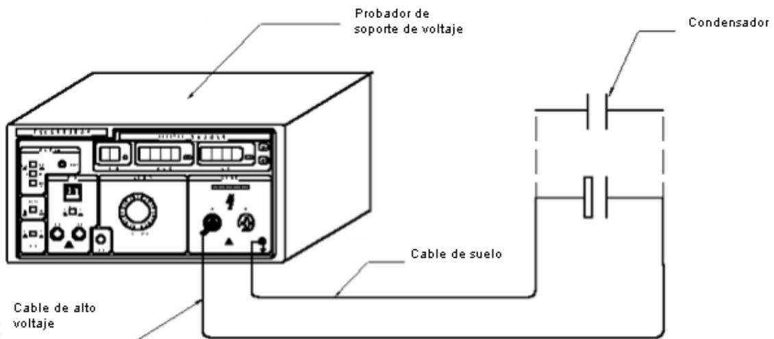
a) Juicio de pila de silicio de alto voltaje y transistor de alto voltaje  $BV_{CEO}$ .
