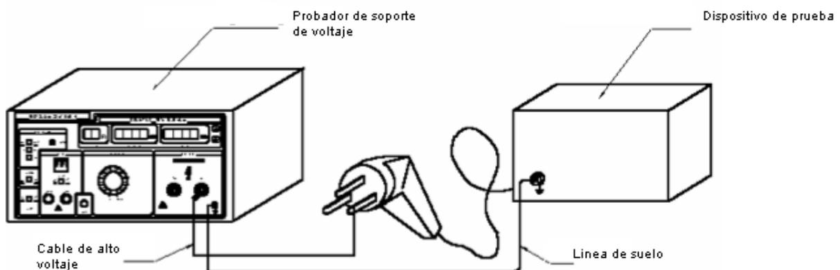
2. Transformador o instrumento eléctrico , intensidad eléctrica prueba de (soporte de intensidad de voltaje).
