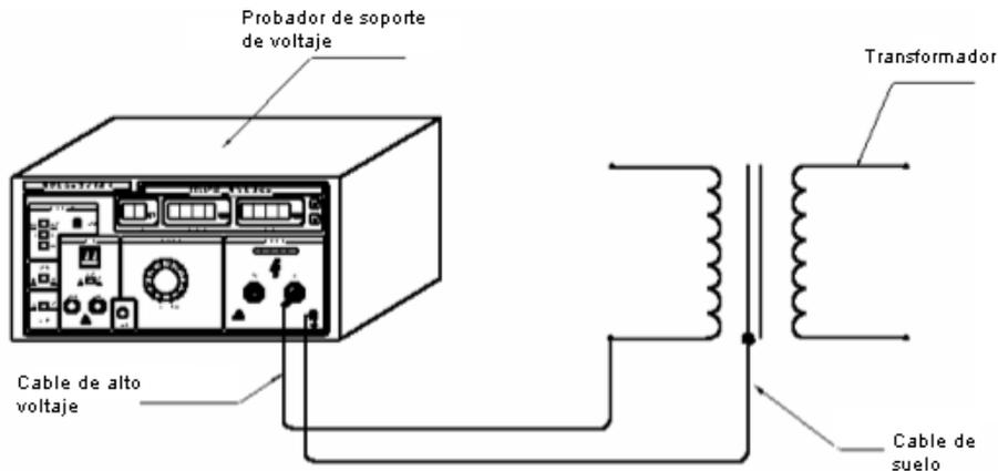
3. Intensidad del condensador eléctrico prueba de (soporte de intensidad de voltaje).
