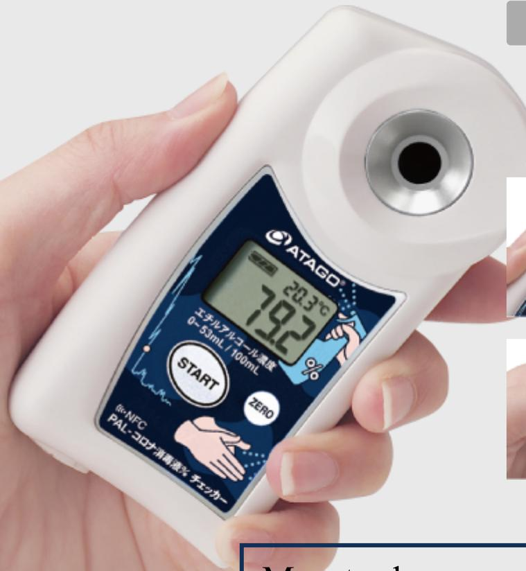
Para medir, primero debe diluir su muestra con la cuchara y el vaso incluidos. Coloque 1 cucharada de etanol y 1 cucharada de agua en el vaso y revuelva bien.
