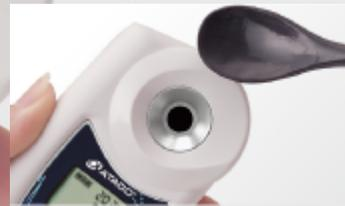
Coloque 0,3 ml en la parte de medición.
